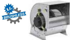
Ventilatori centrifughi a doppia aspirazione ad alta efficienza con motore direttamente accoppiato del tipo E.C. BRUSHLESS e girante con pale rivolte in avanti.
