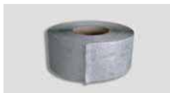
cod. 21NS05 - Nastro alluminio goffrato P3ductal Nastro in alluminio goffrato autoadesivo utilizzato nella costruzione delle condotte. Particolarmente indicato per gli impianti a vista. Il nastro viene fornito in rotoli da 50 metri e in confezioni da 4 rotoli.
